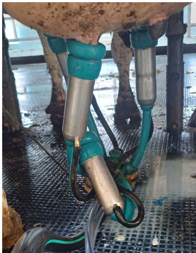
Рис. 3. Доение коров с тремя сосками без использования заглушки не позволяет расположить подвесную часть на вымени ровно. При этом закручивание (заламывание) молочного шланга приводит не только к сокращению сроков эксплуатации коротких молочных шлангов, но и к перекручиванию сосковой резины в стакане. В дальнейшем данный стакан не обеспечит нормального доения доли
